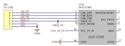
NOTE: THE POWER SUPPLY TO THE MODULE IS 5V , BUT THE MCU IS WOKING UNDER 3.3V , THE ONBOARD LDO WILL REGULATE THE 5V POWER TO 3.3V.
